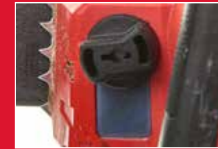
Depósito de óleo antiderrame
