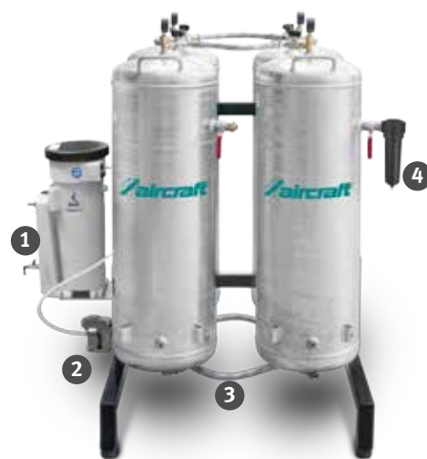
Fig. mostra acessórios KB 4x100/10 (1) Tratamento condensação com alimentação, (2) Purga automática, (3) Mangueiras flexíveis resistentes e (4) Micro Filtro
