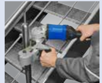
Com braço rotativo para melhor se adaptar às condições de trabalho e material
