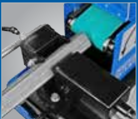
Fig. mostra a lixadeira de cinta posterior com prático suporte para peças e colector de aparas
