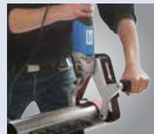
O punho pode ser montado em 3 posições diferentes para melhor se adaptar ao trabalho
