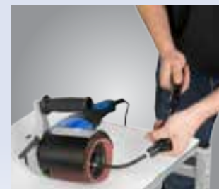
Fixação fácil da manga de lixa, simplesmente bombeando ar para o rolo insuflável.
