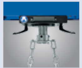
Corrente presa numa falange para auxílio da subida e descida da mesa com o hidráulico
