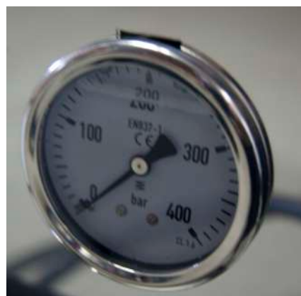
• Manómetro de acero inoxidable y de materiales de alta calidad integrado en la placa trasera de la máquina. Escala de presión en bares (bar).
