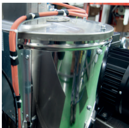
• Caldera de acero inoxidable, resistente a la acción del agua, que alarga la vida útil de la máquina.
